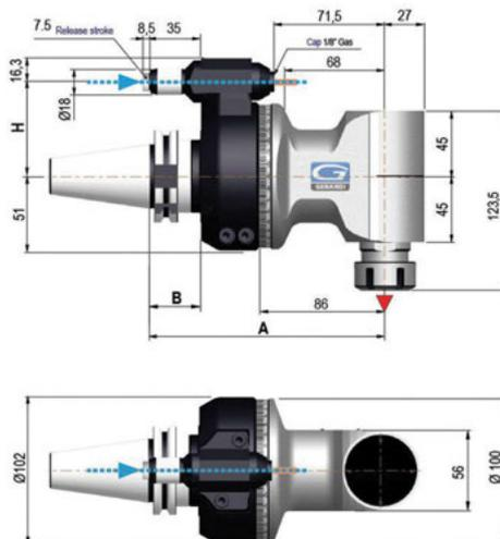
**Мин. отверстие для внутренней обработки**
