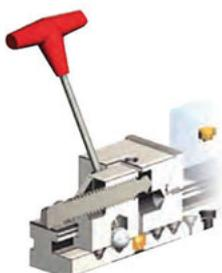
Предварительное закрепление подвижной губки осуществляется при помощи зажима, 2х фиксирующих винтов Т-образным ключом. Винты фиксируют позиционирующий элемент (шарик) в углублении на основании тисков.
