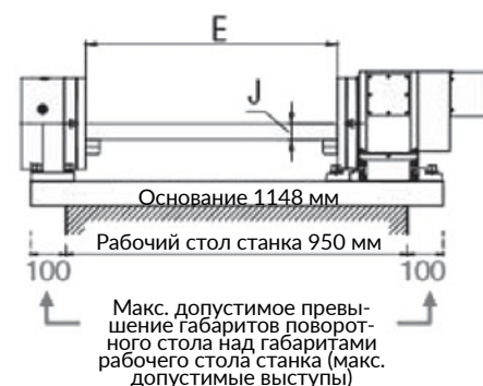
рис. 4: Основание поворотного стола больше габаритов раб. стола
