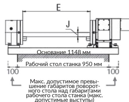
рис. 4: Основание поворотного стола больше габаритов раб. стола
