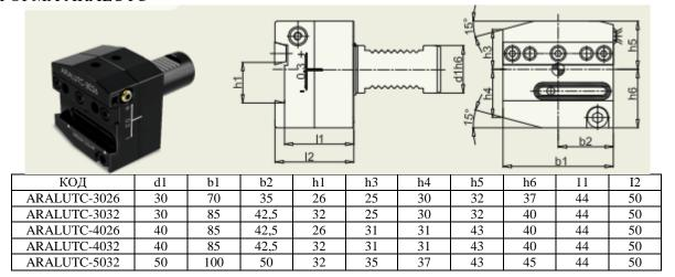
ДЕРЖАТЕЛЬ ОТРЕЗНОГО ИНСТРУМЕНТА ТС – С ОТВЕРСТИЕМ ДЛЯ ПОДАЧИ СОЖ
