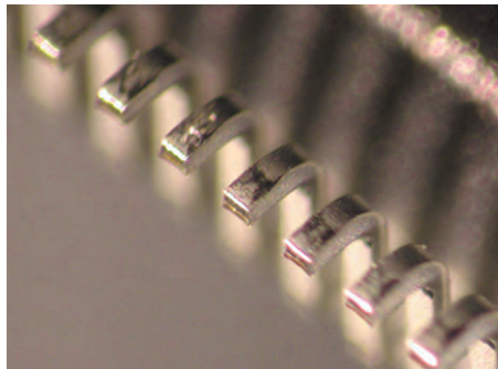
Пример измерения : высота пиков на QFP-корпусе
