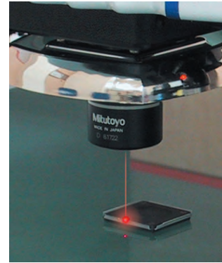
Автофокус коаксиального лазера (LAF)
