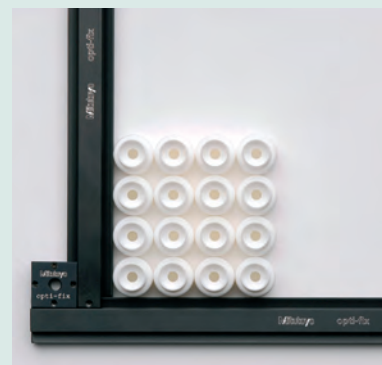
Измерение серии идентичных деталей, позиционирование с помощью прямоугольной рамы.
